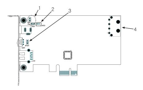
1. JP401, JP402 : External power input jack enable jumper 외부 전원 사용여부를 설정 합니다.
